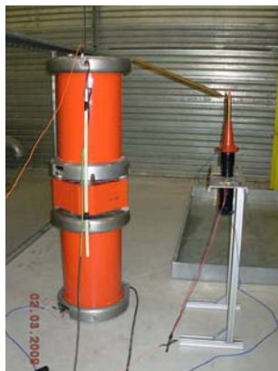
图7: 51 kV 避雷器的例型试验
